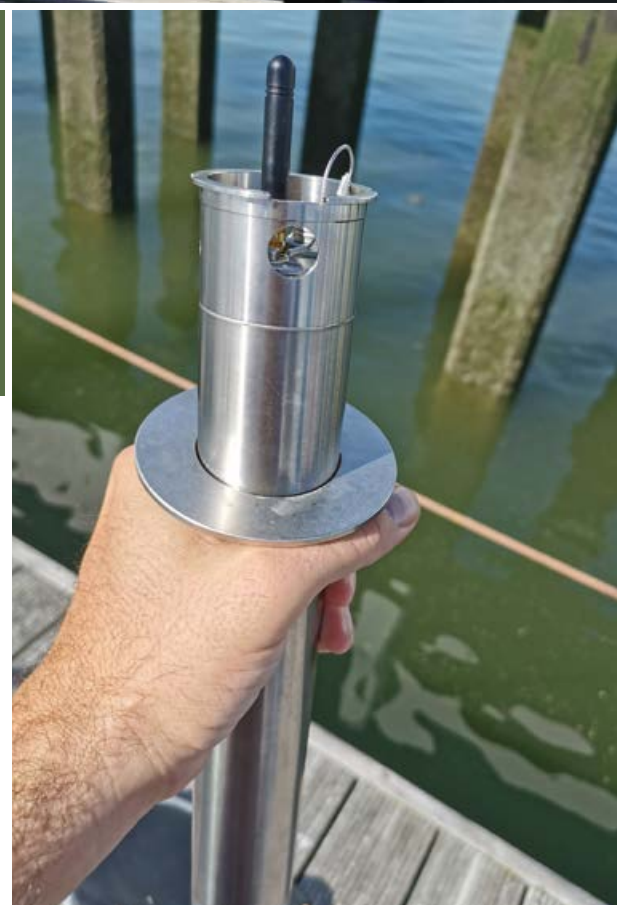
Keller 36 XiW CTD sensoren meten tegelijk druk, niveau, temperatuur en conductiviteit. Een ARC1-tube zorgt voor de communicatie van de data.
